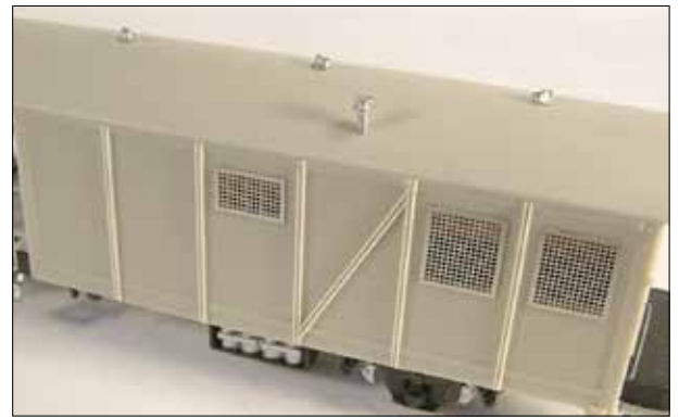
Foto 2: Dakluchters en schoorsteen
